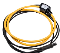
cęgi elastyczne F-1A (Ø 360 mm) 0...3 kA AC (10 kA p-p ) WACEGF1AOKR
