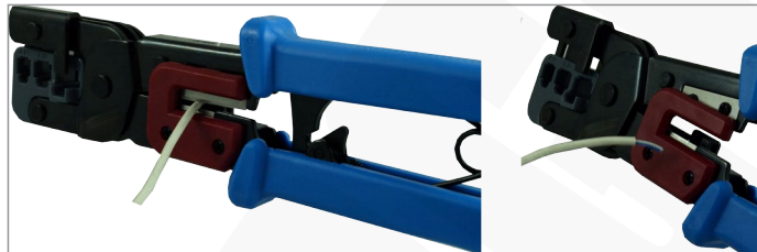
Zdejmowanie izolacji zewnętrznej
